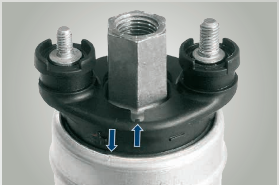
Fig. 69: Tapa de la bomba mal colocada Las bombas de combustible tipo E2T y E3T cuentan con marcas. Estas marcas tienen que estar una enfrente de la otra. Si éste no es el caso, significa que la bomba ha sido manipulada inapropiadamente y se ha averiado.
