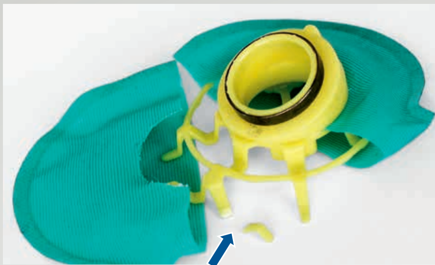
Fig. 76: Aletas de refuerzo rotas en el filtro de una bomba inmersa en el depósito
