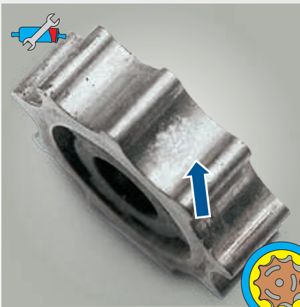
Fig. 49: Engranaje trocoidal con sedimentos de cal
