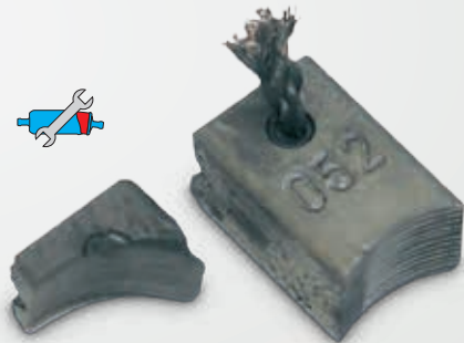
Fig. 62: Contactos deslizantes al cabo de 15.000 km A la izquierda: desgaste prematuro; a la derecha: estado normal para el kilometraje
