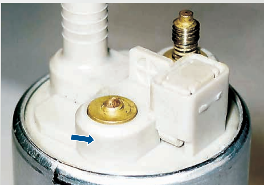
Fig. 75: Averías por impactos en los contactos eléctricos
