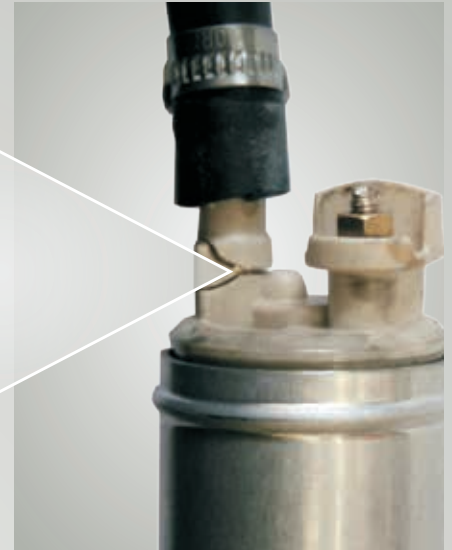
Fig. 74: Racor de manguera partido
