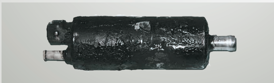
Fig. 65: Bomba en línea usada como una inmersa
