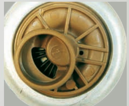
Fig. 35: A modo de comparación: vista de la tubuladora de aspiración de una bomba de canal lateral con rodete intacto.
