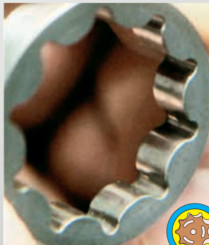
Fig. 51: Engranaje trocoidal (a la izquierda con sedimentos de cal y a la derecha nuevo)
