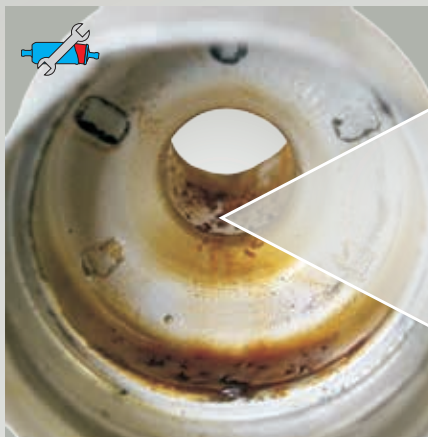
Fig. 64: Sedimentos cristalinos resultantes de un medio inapropiado El origen de esos sedimentos puede saberse únicamente al efectuar complicados análisis químicos de cada caso en particular.
