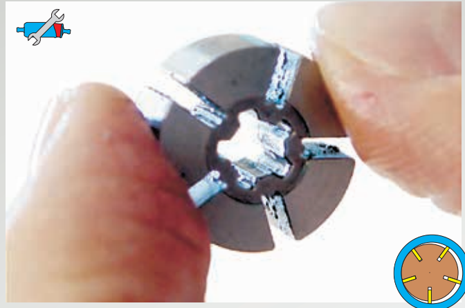
Fig. 30: Mecanismo sucio de una bomba de paletas El rotor está tan sucio de forma que ha inmovilizado cada paleta (aquí retiradas). La bomba sigue “funcionando”, pero ya no bombea.
