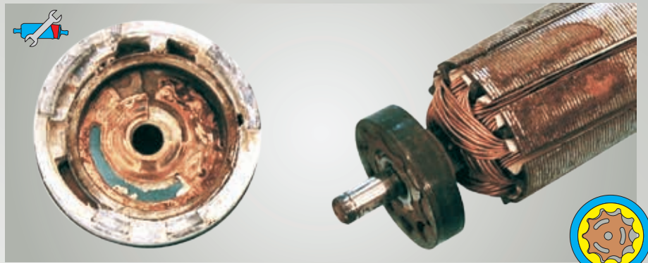
Fig. 37: Bomba de engranaje E3T – Con sedimentos de óxido y cal
