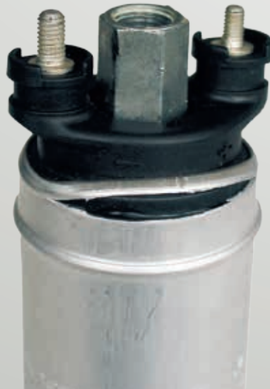
Fig. 1: Averías por impactos No siempre los daños son tan evidentes.
