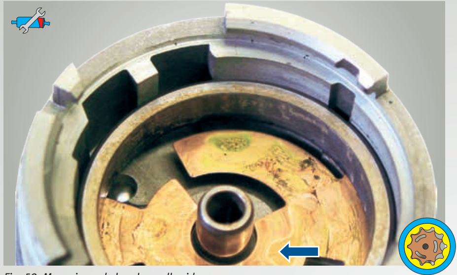
Fig. 59: Mecanismo de bombeo adherido
