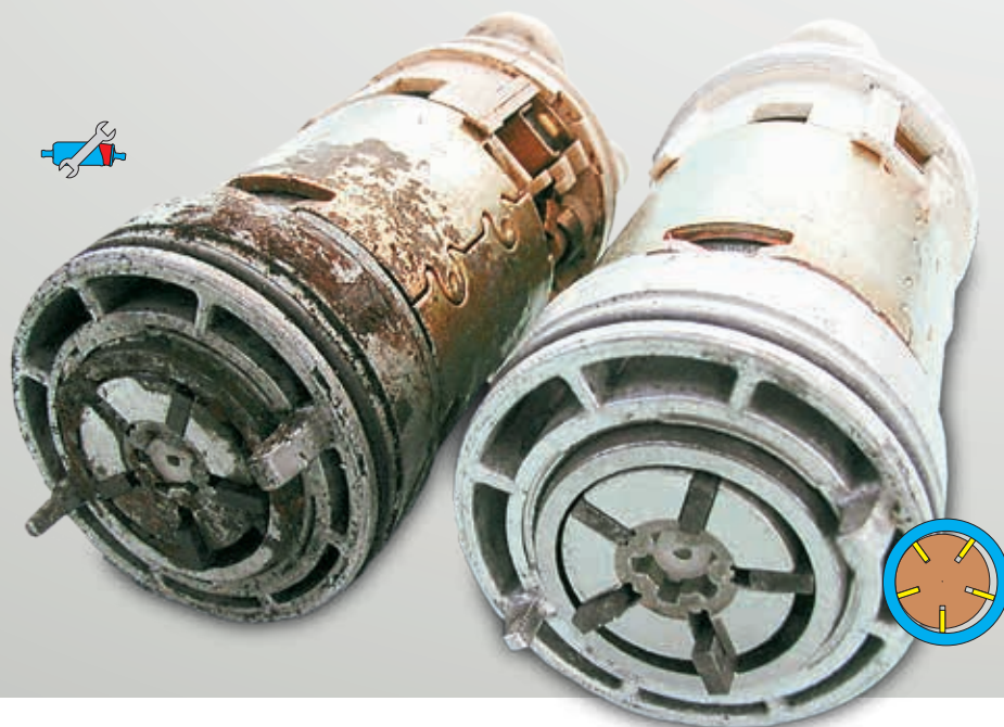
Fig. 36: Daños causados por agua en una bomba con paletas
