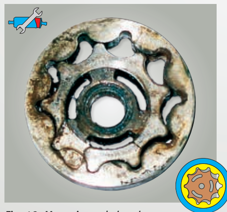
Fig. 19: Mecanismo de bombeo bloqueado (engranaje toroidal) de una bomba de engranaje E3T
