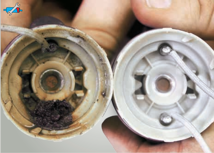
Fig. 46: A la izquierda: contactos eléctricos corroidos; a la derecha: en estado nuevo
