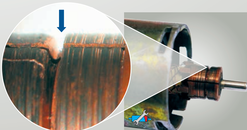
Fig. 62: Contactos deslizantes al cabo de 15.000 km A la izquierda: desgaste prematuro; a la derecha: estado normal para el kilometraje
