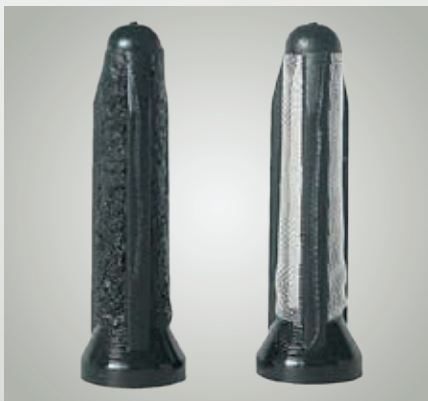
Fig. 22: Tamiz filtrante de una bomba de paletas E1F, obstruida a la izquierda – a la derecha, nueva
