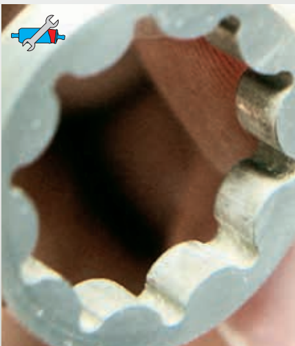
Fig. 51: Engranaje trocoidal (a la izquierda con sedimentos de cal y a la derecha nuevo)
