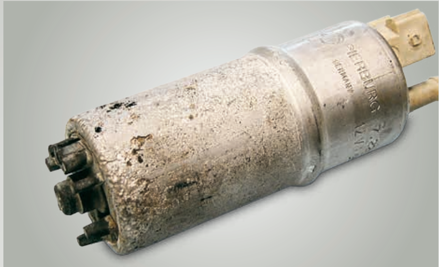
Fig. 72: Corrosión de contacto debida a la selección incorrecta de materiales
