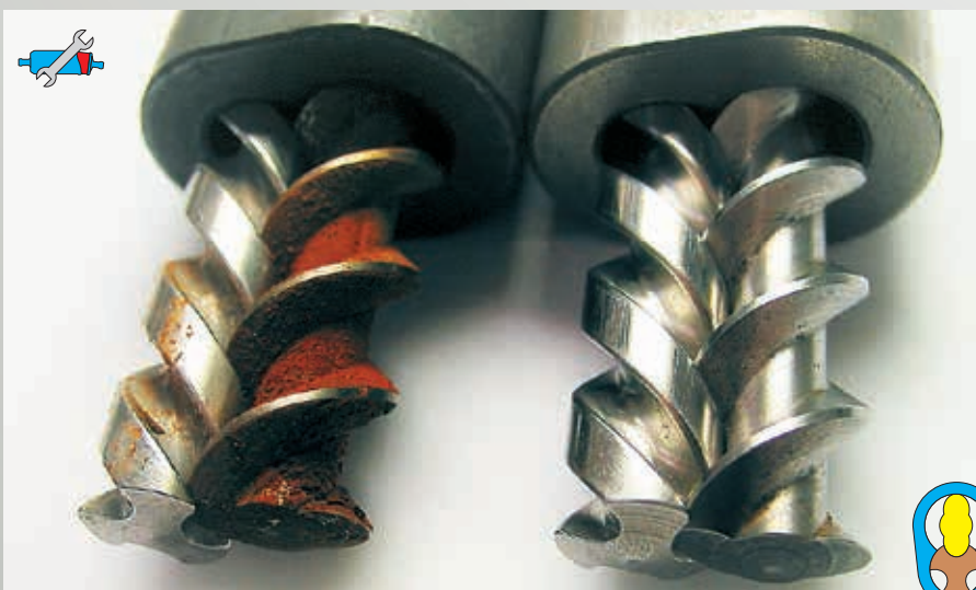
Fig. 54: Bomba helicoidal (a la izquierda, oxidada; a la derecha, nueva)
