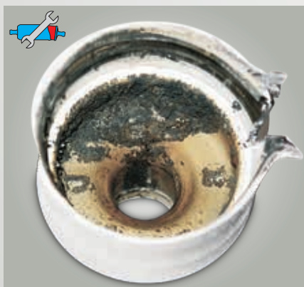
Fig. 18: Vista de una carcasa cortada de una bomba de engranaje E3T – averiada por sedimentos
