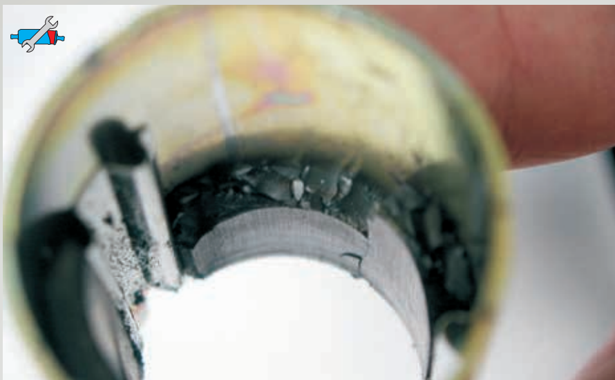
Fig. 80: Imán permanente resquebrajado (estátor)
