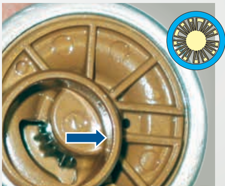
Fig. 34: Las aletas del rodete de una bomba de canal lateral del tipo E1S han quedado destrozadas por un cuerpo extraño (izquierda).
