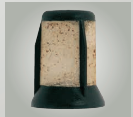
Fig. 23: Tamiz filtrante sucio de una bomba de engranaje E3T
