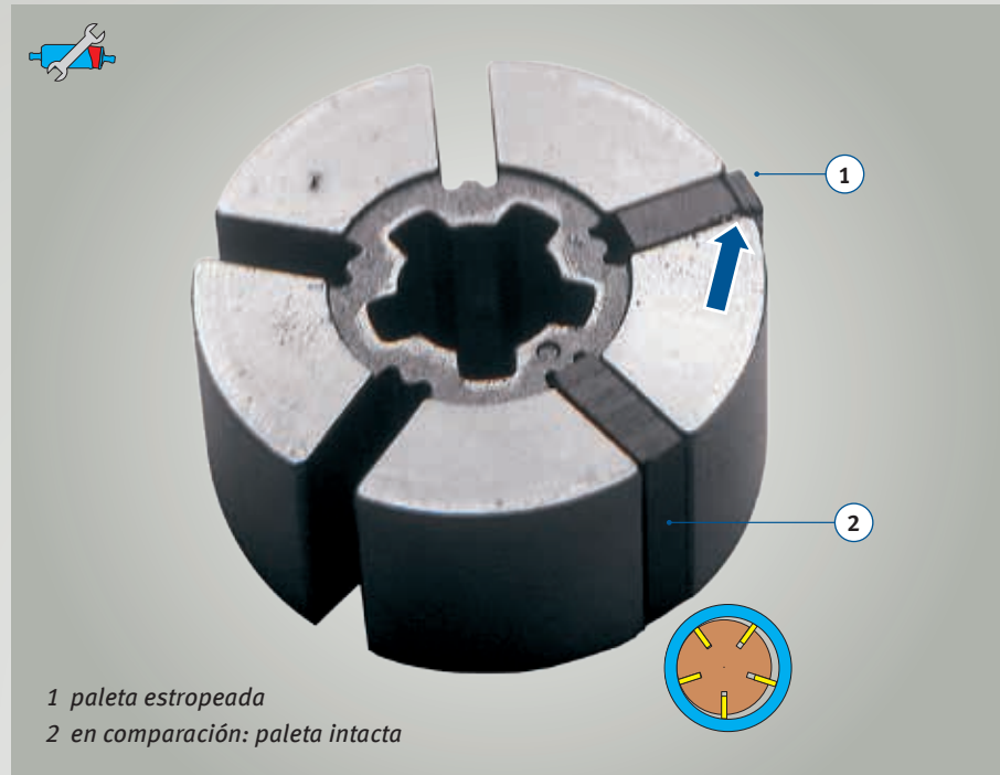
Fig. 24: Mecanismo de una bomba de paletas - Daños debidos a cuerpos extraños La paleta superior derecha está sumamente dañada por un cuerpo extraño. A título comparativo, una paleta intacta abajo a la derecha.
