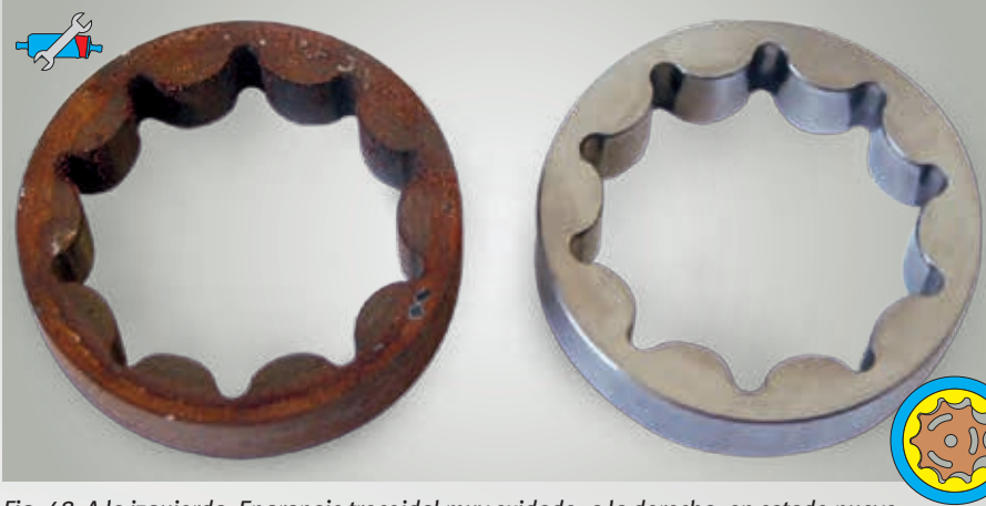
Fig. 48: A la izquierda: Engranaje trocoidal muy oxidado; a la derecha: en estado nuevo
