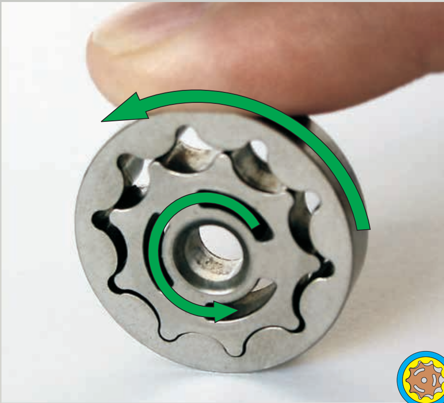
Fig. 52: Un mecanismo trocoidal tiene que poder girar siempre con facilidad
