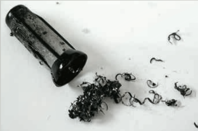
Fig. 29: Virutas en el tamiz filtrante En este caso, las virutas de metal han penetrado en el depósito de combustible al realizar trabajos en el sistema de alimentación de combustible. Las virutas de cantos afilados han dañado el tamiz filtrante. Por este motivo, la suciedad ha entrado en la bomba y ha bloqueado el mecanismo de bombeo.
