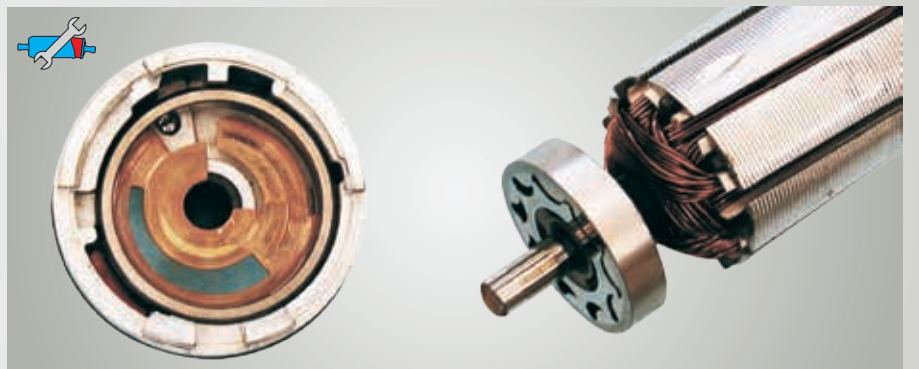
Fig. 38: En comparación: Bomba de engranaje E3T – En buen estado a pesar de un largo período de servicio
